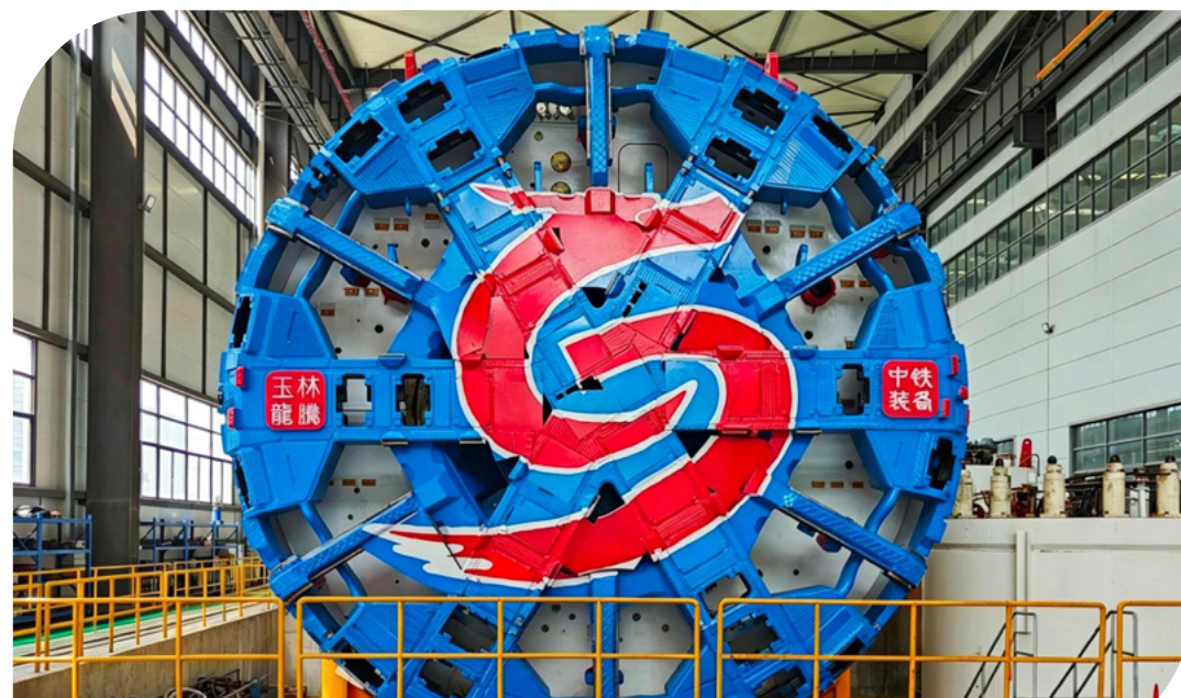
厦工中铁 088 号 8 米级复合盾构机
